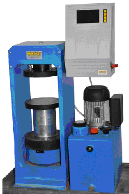
Rys. 6.3. Prasa hydrauliczna do badania wytrzymałości na ściskanie.
