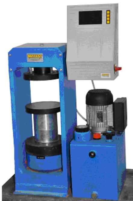
Rys. 6.3. Prasa hydrauliczna do badania wytrzymałości na ściskanie.
