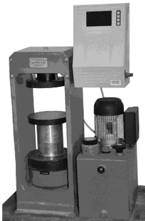
Rys. 11.1. Prasa hydrauliczna do badania wytrzymałości na ściskanie.
